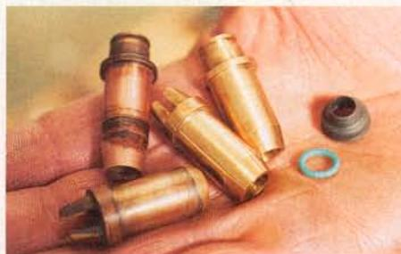
Nach Experten-Erfahrung bei jeder Motorüberholung fällig: Tausch der Ventilführungen
