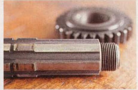
Verschleiß möglich: die Aufnahme des fünften Gangrads auf der Getriebeabtriebswelle
