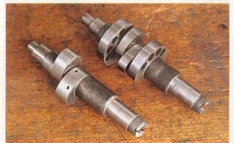
Reichlich Profil: Links die Nockenwelle der „Federmotoren“, rechts das Desmo-Teil
