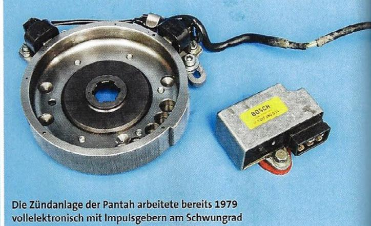
Die Zündanlage der Pantah arbeitete bereits 1979 vollelektronisch mit Impulsgebern am Schwungrad
