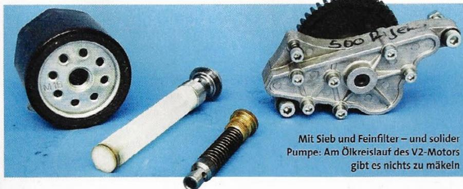
Mit Sieb und Feinfilter – und solider Pumpe: Am Ölkreislauf des V2-Motors gibt es nichts zu mäkeln
