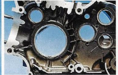
Verstärkt: 650er und 750er Gehäuse sind im Hauptlagerbereich üppiger verrippt
