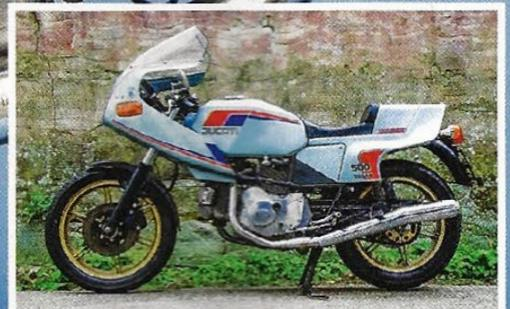
Die 1979 erschienene **Ducati Pantah** begründete eine neue Epoche in der Geschichte des Motorradbauers aus Bologna. Zahnriemen statt Königswellen zum Antrieb der Nockenwellen waren die größte Neuigkeit. Wir betrachten den „Gummiband-Motor“ im Detail
