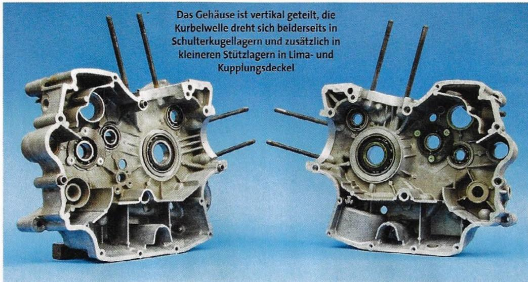
Das Gehäuse ist vertikal geteilt, die Kurbelwelle dreht sich beiderseits in Schulterkugellagern und zusätzlich in kleineren Stützlager in Lima- und Kupplungsdeckel
