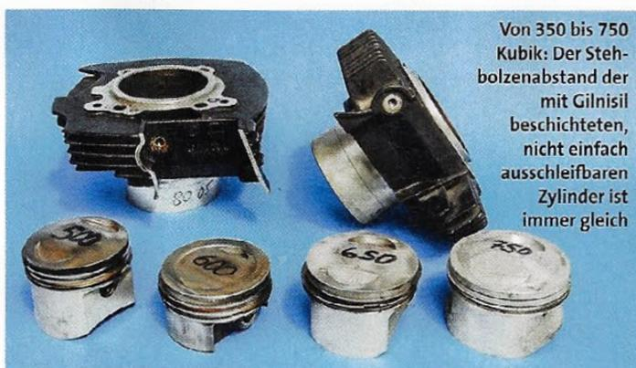
Von 350 bis 750 Kubik: Der Stehbolzenabstand mit Gilnisl beschichteten, nicht einfach ausschleifbaren Zylinder ist immer gleich
