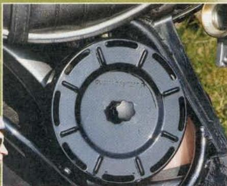
Der Original-Luftfilter geriet recht eigenwillig – aber wer fährt eine Duc mit Luftfilter?
