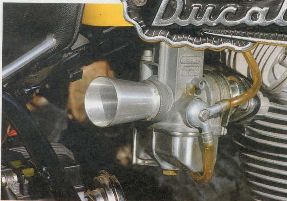
**Kommen Sie auf den Trichter! Ein Dell'Orto-Vergaser der Serie VHB mit Rechteckschieber beatmet das Einzylindertriebwerk. Gehört hier wirklich ein monströser Luftfilter hin?**
